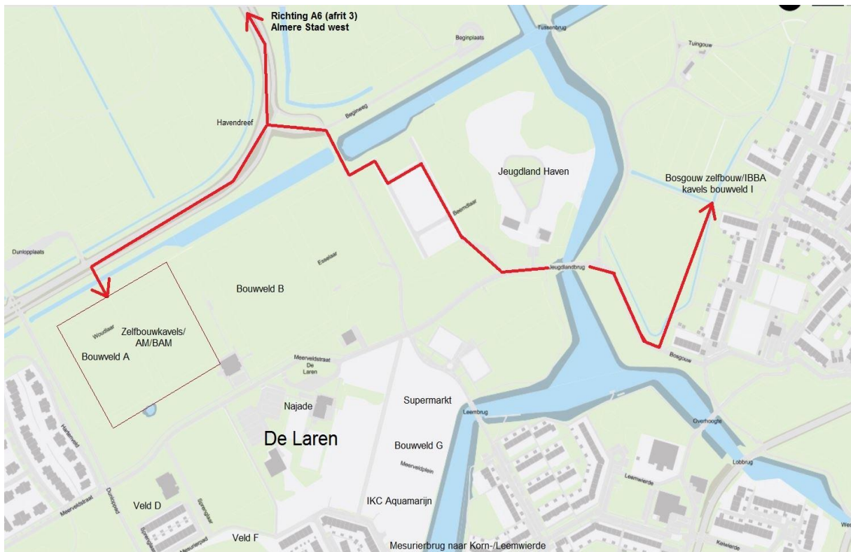
Aan- en afvoerroute bouwverkeer vanaf de A6 naar de Laren (Woudlaar veld A / Bosgouw veld I)
